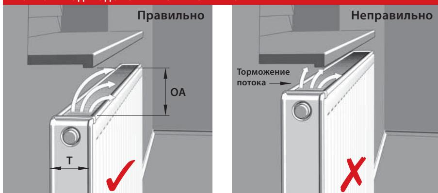
100% теплоотдача возможна только тогда, когда сверху и снизу радиатора нет предметов, препятствующих воздушному потоку, когда под радиатором и над радиатором остались отступы. Верхний отступ можно просчитать так: **глубина радиатора + 10%**
