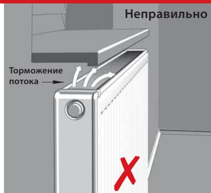
100% теплоотдача возможна только тогда, когда сверху и снизу радиатора нет предметов, препятствующих воздушному потоку, когда под радиатором и над радиатором остались отступы. Верхний отступ можно просчитать так: **глубина радиатора + 10%**
