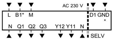
L, N Betriebsspannung AC 230 V
