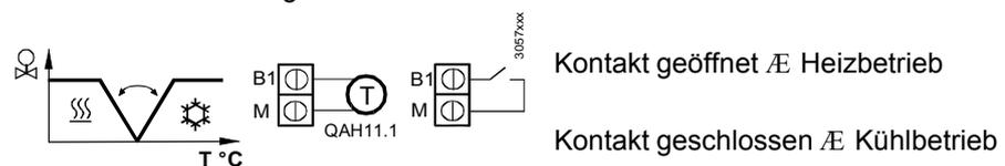
Mit Parameter P99 (Diagnosewert) kann die automatische Heiz- und Kühlbetrieb-Umschaltung überprüft werden.
