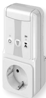
Rádiós szabályozóegységszett (falon kívüli kivitel)
