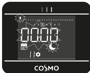
Wenn alle Tage programmiert sind, wird das Wort **End** angezeigt. Um das Programm zu speichern, drücken Sie die Taste (M), um zu bestätigen.
