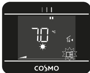
Die Erkennung des Temperaturabfalls löst den Wechsel in den Frostschutz-Modus aus.
