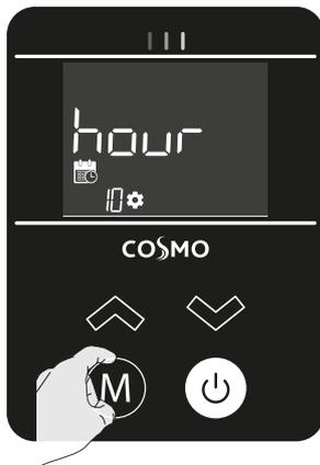
Bei einem Stromausfall von mehr als mindestens 2 Stunden gehen die Uhrzeit- und Tageseinstellungen verloren und müssen zurückgesetzt werden. Sie können Uhrzeit und Tag zurücksetzen, indem Sie die oben gezeigten Schritte wiederholen.
