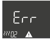
Heizpatronensensor defekt. Überprüfen Sie die Montage des Handtuchwärmers.
