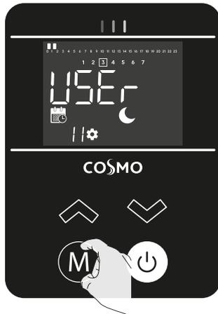
Die erste reduzierte Phase blinkt. Wiederholen Sie den Vorgang zur Programmierung eines Tages.
