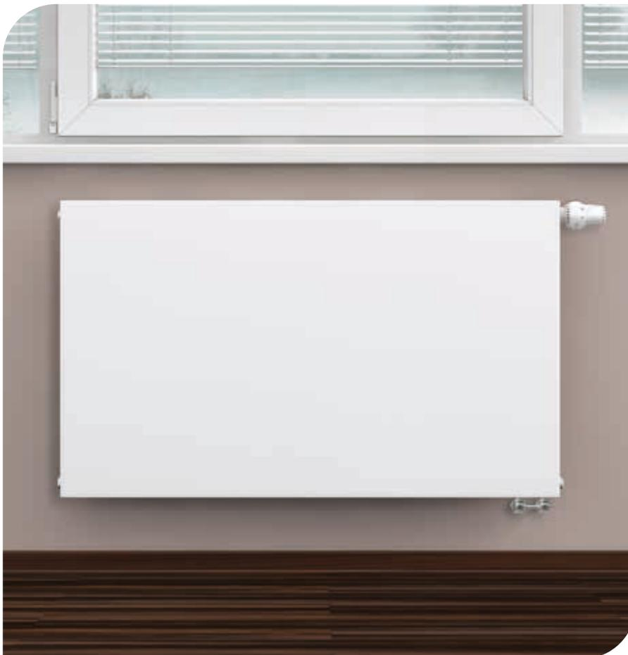
Der **COSMO** Plan Multifunktionsheizkörper mit eingeschweißter Ventilgarnitur ist sowohl für Zweirohranlagen als auch für Einrohranlagen unter Verwendung eines Einrohrverteilers geeignet. Zusätzlich zum Anschluss von unten ermöglicht die technisch ausgereifte Konzeption auch andere, von Kompaktheizkörpern bekannte Anschlussmöglichkeiten, wie einseitiger und wechselseitiger Anschluss.
