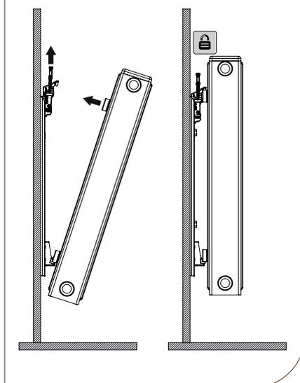
**Montage:** Heizkörper mit der unteren Lasche in den Konsolenfuß setzen und den HK gegen das Oberteil drücken – das hochgezogene Oberteil senkt sich über die Lasche. Danach die Inbusschraube festdrehen. Zur Demontage das Oberteil am Griff hochziehen – Achtung der HK kann dadurch nach vorne fallen – den HK dann vom Konsolenfuß nehmen.
