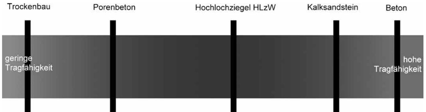
Welcher Baustoff verwendet wird, hat wesentlichen Einfluss auf die Tragfähigkeit der Befestigung – ...oder, je geringer die Tragfestigkeit des Baustoffes, desto geringer die Belastbarkeit.
