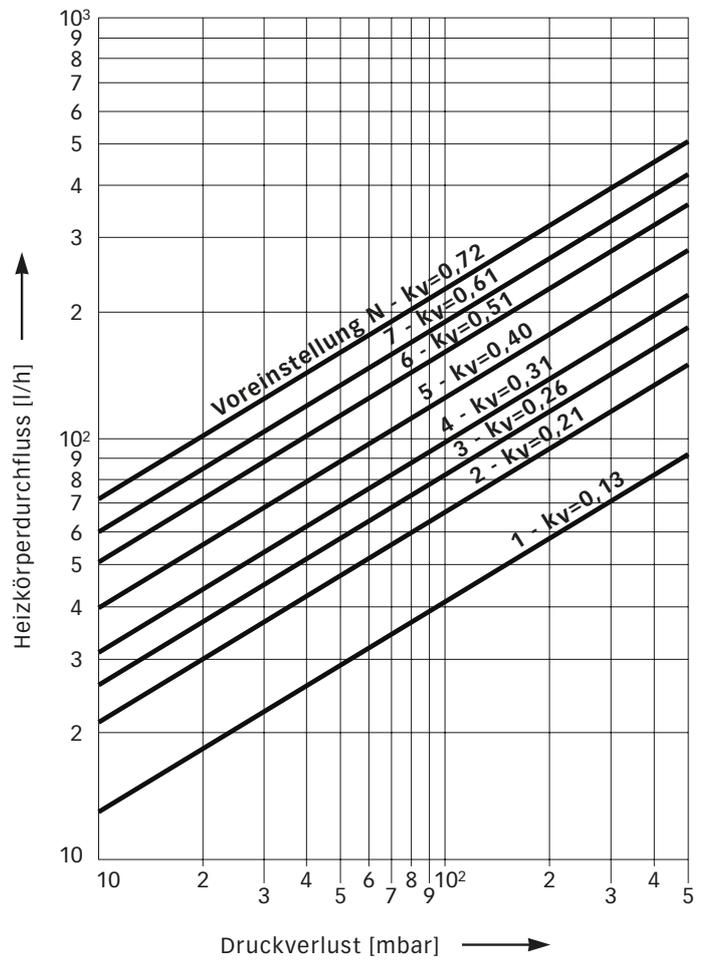
**Diagramm 1** Druckverlust [mbar] - Zweirohrbetrieb bei 2K Proportionalabweichung
