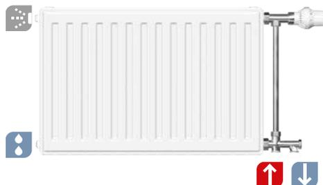
Kompaktheizkörper können problemlos auf Einrohranschluss umgerüstet werden. Voraussetzung ist, dass dabei Vierwegeventile mit Umgehungsrohr verwendet werden.
