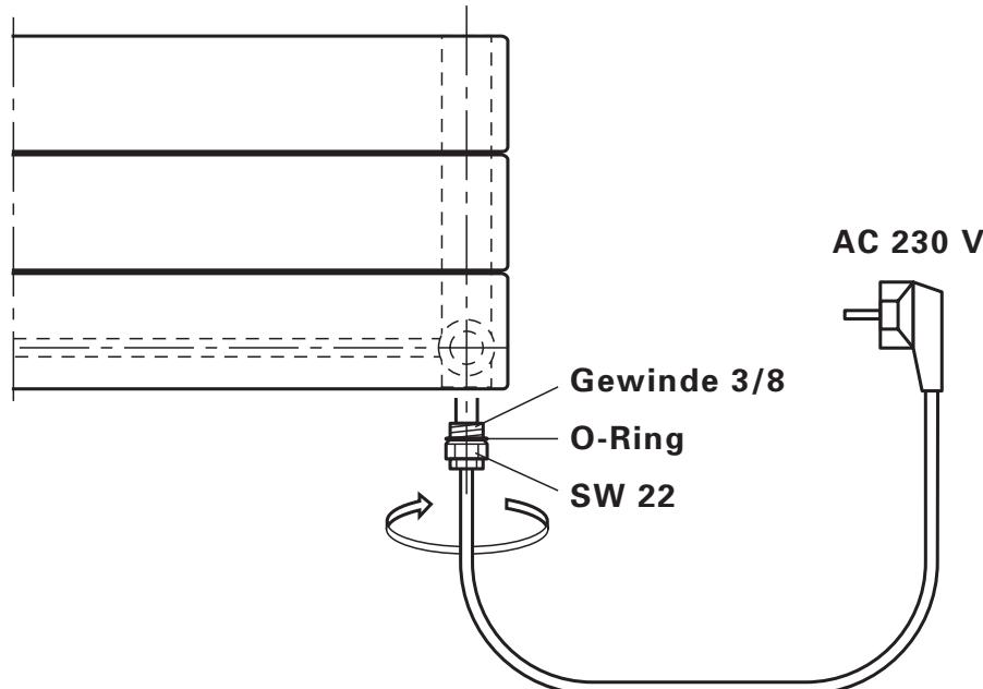
Beim Anschluss des Designheizkörpers, mit oder ohne eingebautem PTC-Elektroheizelement an die Warmwasserheizungsanlage, muss die Ausdehnung des Wasserinhalts bis zum Expansionsgefäß auch bei geschlossenem Vorlaufventil, ständig gewährleistet sein.
