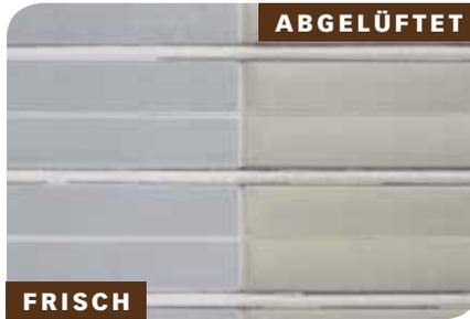
Ecofix dünn auftragen und ablüften lassen. Nachdem das Wasser vollständig verdunstet ist, haftet der Kleber und verfärbt sich dunkelgelb.
