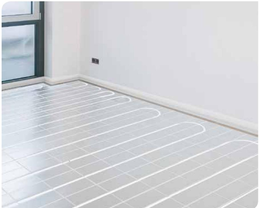
Fertig verlegte Fläche System EPS – Bis zur Verlegung der Lastverteilschicht oder des Oberbodens Laufwege, z.B. mit Dämmplatten, vor Stauchung schützen
