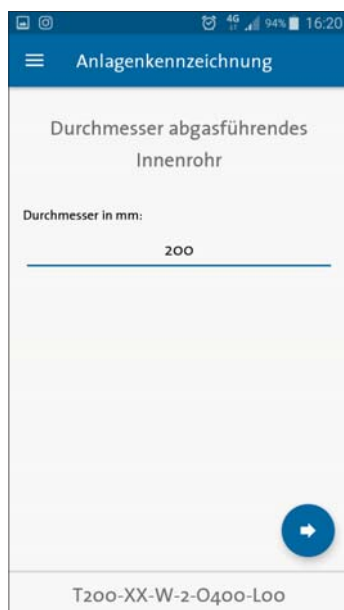
Installierten Durchmesser eingeben
