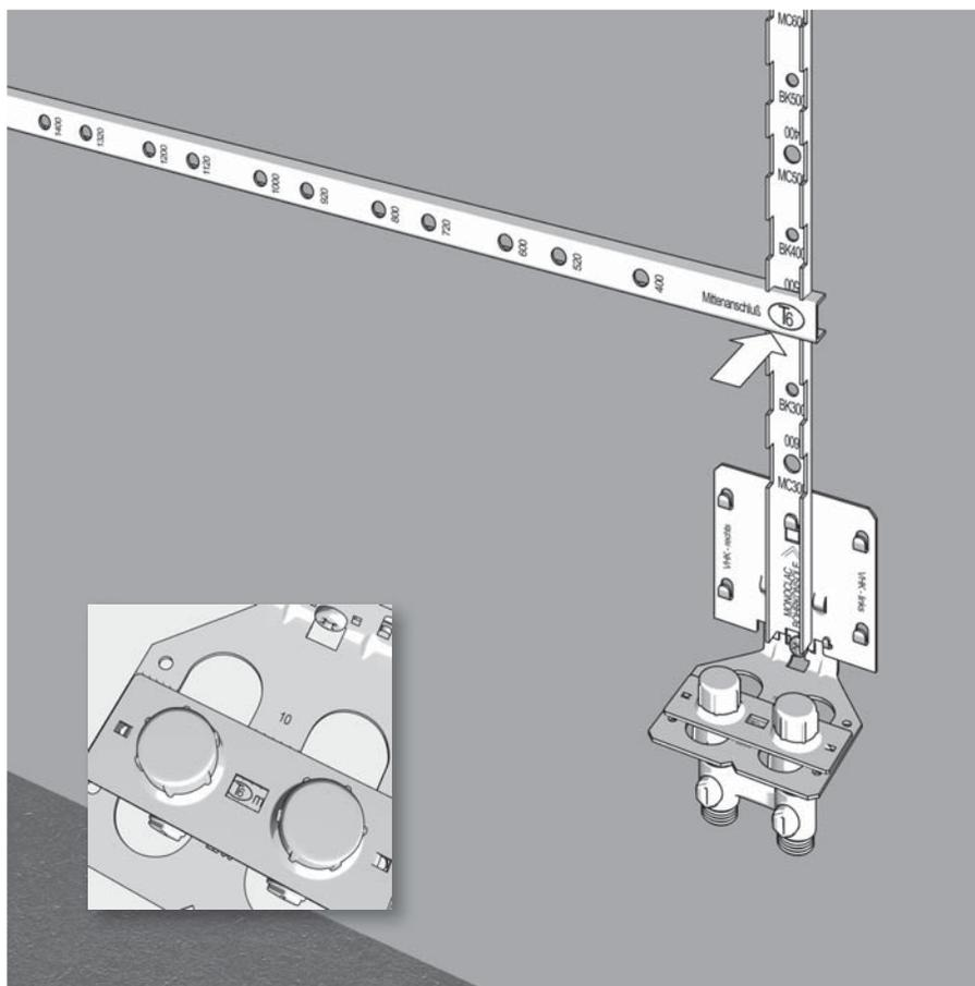
In Verbindung mit der **Adapterplatte**, die mit einfachen Handgriffen auf den **Montagewinkel für Rohwandmontage** aufsteckbar ist, können auch die Vorteile des **Profilleistensets** optimal genutzt werden. Selbstverständlich kann auch der **Spülbogen** in Verbindung mit der **Montageschablone - 3/4" A.G. für Rohwandmontage** verwendet werden, um die Anlage zu spülen und die Systemprüfung ohne Heizkörper durchführen zu können.
