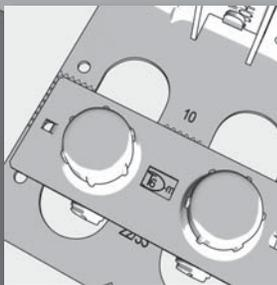
**Spülbogen** in Verbindung mit der Montageschablone 3/4" A.G. ermöglicht ein problemloses Spülen der Anlage und Systemprüfung ohne Heizkörper
