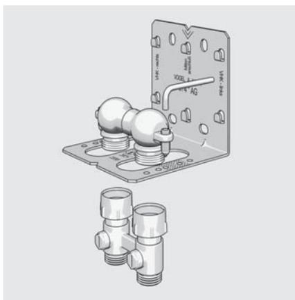
Aufstecken der vertikalen Montageschiene. Kennzeichnung der mittleren Montagebohrung bei Heizkörpern ab Baulänge 1800 mm. Bei Verwendung der Spezialwinkellasche Z0BU00012002000 sind die vertikalen Montageschienen Z0FT060R1V01000 für die Bauhöhen 300 - 600 mm bzw. Z0FT090R1V01000 für die Bauhöhe 900 mm zu verwenden. Das im Verbindungsbügel eingebrachte Fenster dient zur Kontrolle der richtigen Bautiefenauswahl
