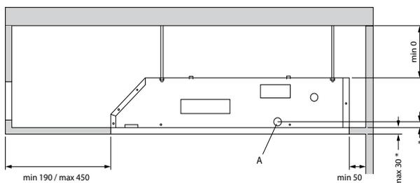
**Hinweise:** Die Montage mit dem Metallgehäuse für Einbau **L** kann direkt unter der Decke oder hängend erfolgen!
