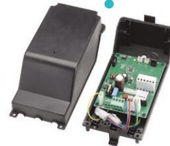
interne Steuerplatine 0-10 V DC
