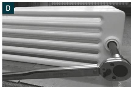
Führen Sie die Nippelstange durch einen Anschluss- vom zuletzt angesetzten Block - bis in den Nippel. Der Sechskant an der Nippelstange ist für die Nuss des Drehmomentschlüssels vorgesehen.
