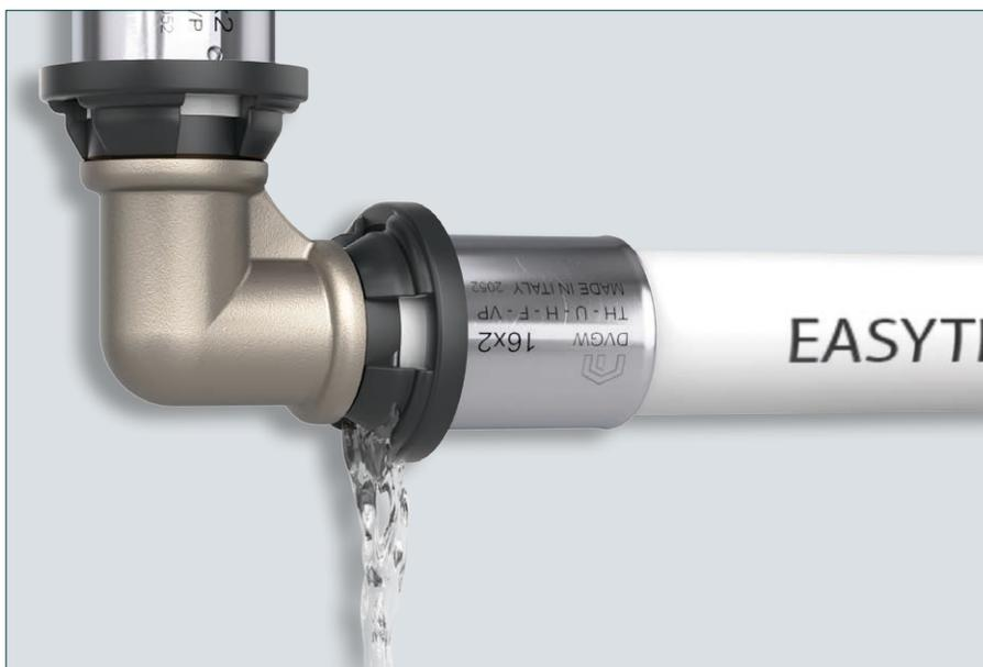
Die Montage der EASYTEC Fittings erfolgt per Radialpresstechnik. Der Fitting mit Leckagefunktion (unverpresst undicht nach DVGW) ist mit 5 verschiedenen Konturen in den Dimensionen 16-32 mm verpressbar.
