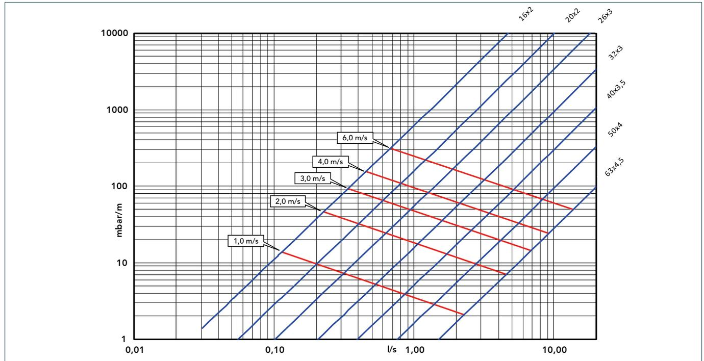
Potenzialorientierte Nennweitenbestimmungen sowie Dimensionierungen der Zirkulationsleitungen nach DVGW-Arbeitsblatt W 553 sind mit spezieller Planungssoftware einfach und rasch durchzuführen.
