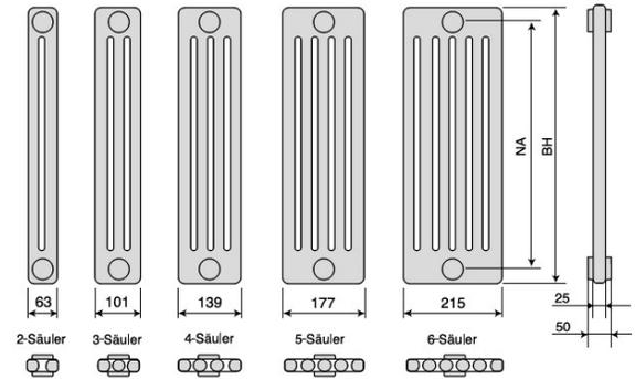
Nabenabstand (NA) = Bauhöhe minus 65 mm, auf Wunsch jede Bauhöhe zwischen 300 und 3000 mm millimetergenau erhältlich.
