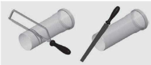
Beim Ablängen der Rohre ist darauf zu achten, dass gerade abgesägt wird, danach ist die Schnittkante mit einer Feile anfasen.
