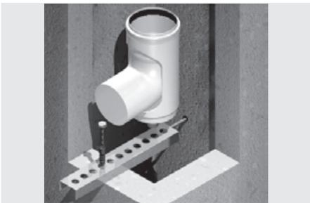
Je nach Ausführung des Verbindungsstückes kann direkt nach dem Stützbogen eine **Prüföffnung** notwendig werden. Sonst ist nach max. 15 m eine Prüföffnung erforderlich. Stimmen Sie sich dazu mit dem zuständigen Schornsteinfegermeister/-in ab. Beachten Sie die gekennzeichnete Einbaurichtung auf dem Bauteil.
