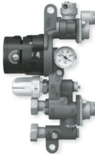
Montage: Der Verteiler wird direkt mit der Etagenregelstation verbunden. Es werden lediglich die werkseitig montierten Kugelhähne demontiert und die Etagenregelstation mit dem 1" A.G. Anschlusssteil direkt mit der Überwurfmutter des Edelstahlverteilers verbunden. Es muss unbedingt darauf geachtet werden, daß die Dichtflächen sauber und fettfrei sind. Eine passende 1" Flachdichtung befindet sich im Lieferumfang des Verteilers und ist werkseitig montiert.
