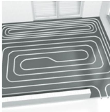
Abb. 3: schneckenförmige Verlegung mit integrierter Randzone
