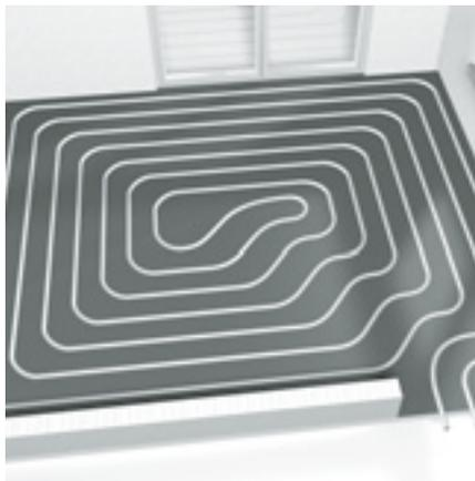
Abb. 2: schneckenförmige Verlegung
