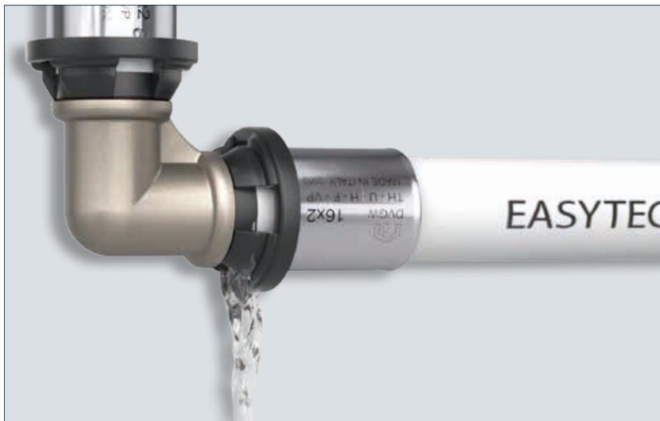
Die Montage der EASYTEC Fittings erfolgt per Radialpresstechnik. Der Fitting mit Leckagefunktion (unverpresst undicht nach DVGW) ist mit 5 verschiedenen Konturen in den Dimensionen 16-32 mm verpressbar.
