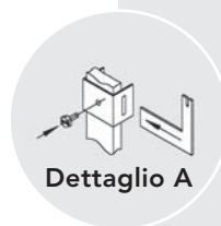
Figura B: Montare la staffa a U (disponibile come accessorio) con gli elementi di supporto sulla base d'appoggio.
