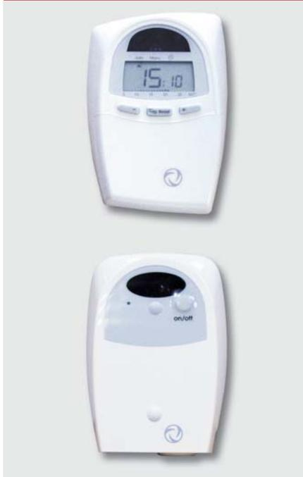
Digital Raumthermostat mit Infrarot Übertragung inkl. PTC-Elektroheizelement, zur Raumtemperaturregelung der Designheizkörper. Der Infrarotsender verfügt über eine übersichtliche LCD-Anzeige mit gleichzeitiger Anzeige von Raumtemperatur, Solltemperatur, Betriebsart und BOOST-Symbol.
