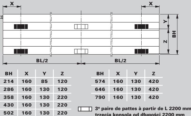
**Attention: Respecter impérativement le palier de pression admissible (5,0 ou 8,0 bars) et la température admissible (110 °C).**
