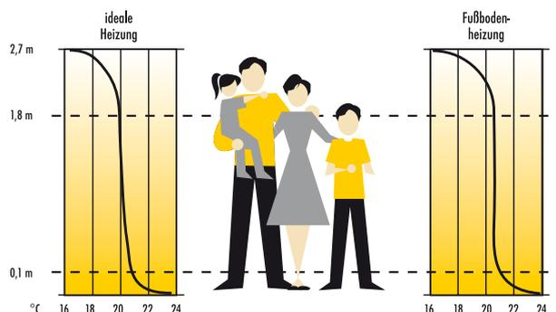
Die vertikale Verteilung der Heizwärme ist verantwortlich für das Wohlbefinden zuhause. Die Fußbodenheizung erreicht hier grundsätzlich mehr Wärme im Raum - zwischen 0,1 und 1,80 m – und hält diese auch gleichmäßig.
