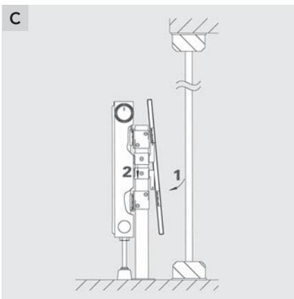
**Bild C:** Einhängen des Strahlungsschirmes in die oberen Halteteile und in der Baulänge ausrichten. (Achtung: Die Bohrungen der Planplatte müssen dem Fußboden zugewandt sein.) Dann den Plan-Strahlungsschirm in der Bauhöhe so ausrichten, dass dieser mit der Heizkörperoberkante abschließt. Danach den Plan-Strahlungsschirm mit den unteren Halteteilen über die unteren Aufhängelaschen fixieren.
