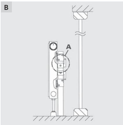
**Bild B:** U-Bügel (als Zubehör erhältlich) mit Halteteilen auf die Standkonsole montieren.
