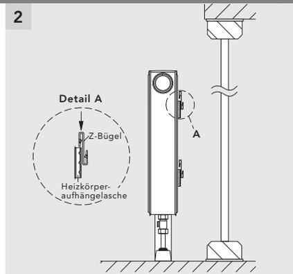
**Bild 1** Heizkörper mit innenliegenden Standkonsolen vor einer transparenten Außenfläche.
