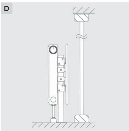
**Bild D:** Heizkörper mit montiertem Plan-Strahlungsschirm.
