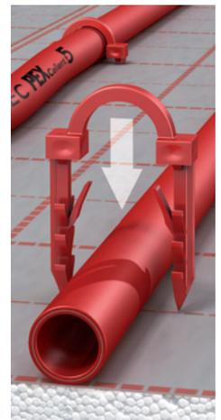
Das FLOORTEC 3D-Tackersystem dient zugleich als hochwertige Trittschall- und Wärmedämmung. Dank des integrierten Bändchengewebes verfügt die Dämmung über extreme Haltekraft der Heizrohrhalter und gute Begehbarkeit sowie hohe Trittschallstabilität während der Montage. Die Fixierung des Heizrohres erfolgt durch spezielle Heizrohrhalter, die mit Hilfe eines Tackerstocks in die Dämmung eingebracht werden. Mit dem FLOORTEC 3D-Tackersystem sind auch große Flächen schnell und einfach zu verlegen.
